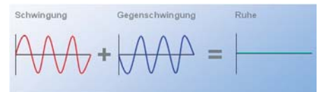
Funktionsprinzip der aktiven Schwingungs-isolation
